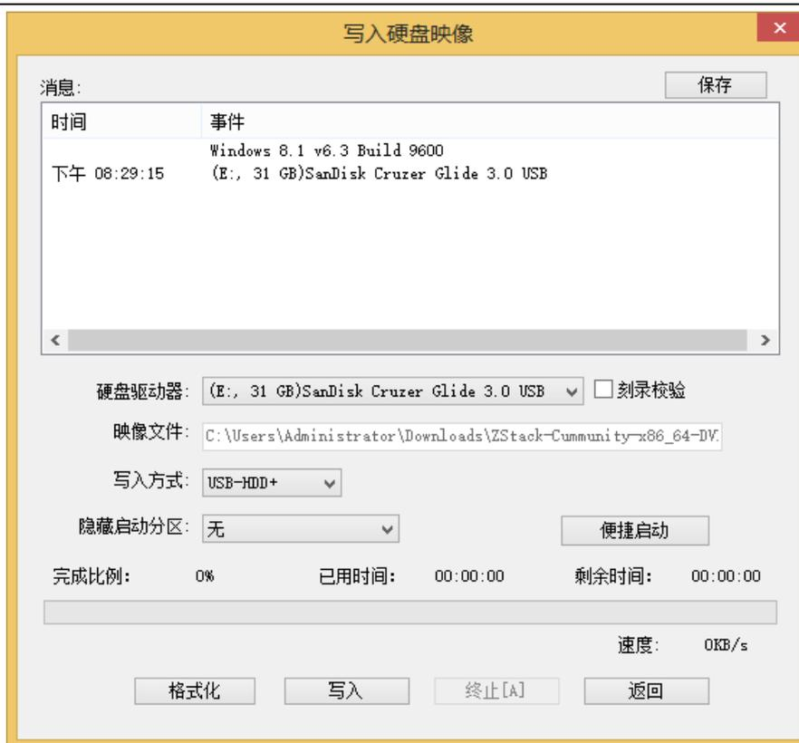
图四 在 UltraISO 确认写入 ZStack DVD 镜像
